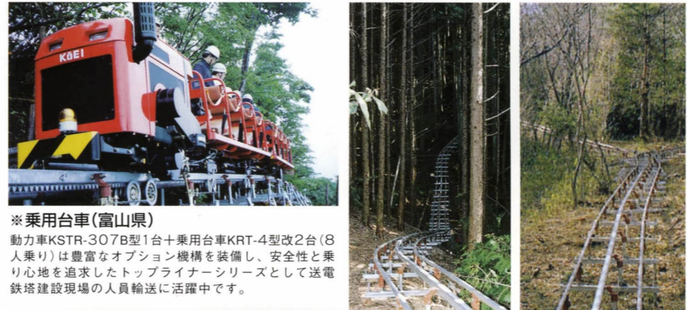
※乗用台車(富山県) 動力車KSTR-307B型1台+乗用台車KRT-4型改2台(8人乗り)は豊富なオプション機構を装備し、安全性と乗り心地を追求したトップライナーシリーズとして送電鉄塔建設現場の人員輸送に活躍中です。 ※3条式(特許登録) 自在な架設(静岡県) 用地幅1.2m~1.5mで曲率半径12m(地盤状況により9~10m迄可能)で架設出来る為、左右上下自在カーブで樹間を縫って走行するので伐採はきわめて少なくて済みます。 ※3条式、分岐 分岐ポイントを利用して、複数現場の効率的運用が可能です。
